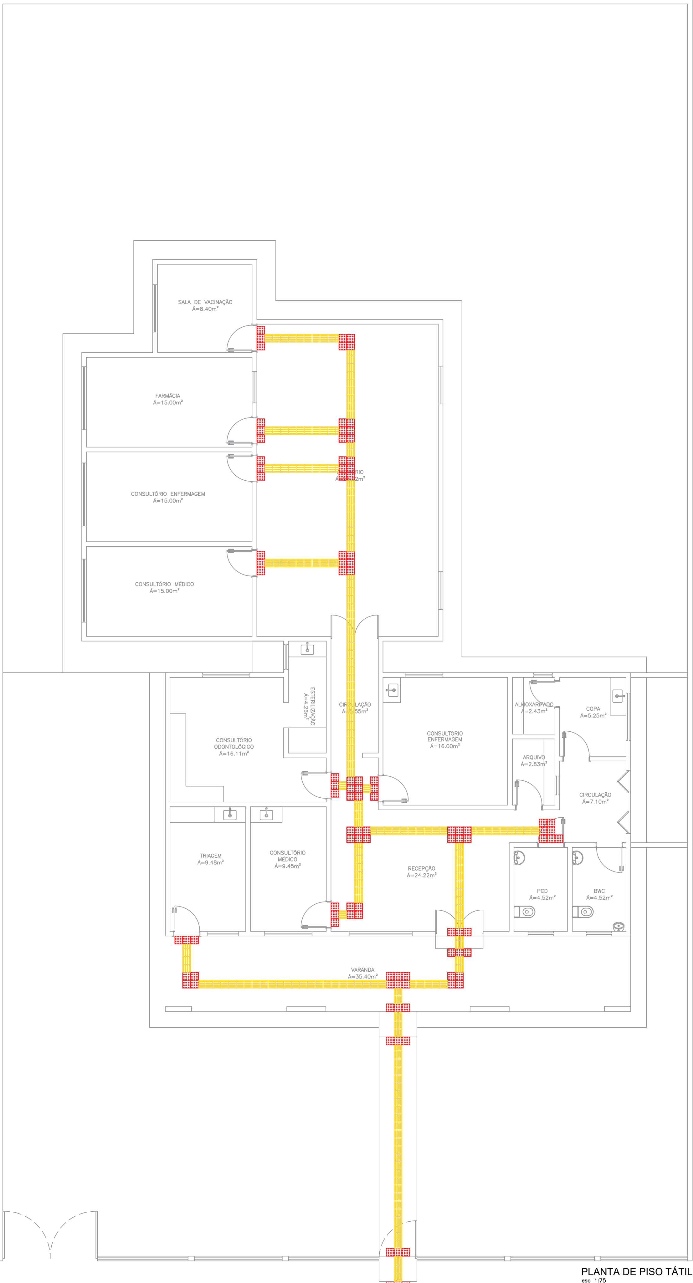
PLANTA DE PISO TÁTIL esc 1:75
